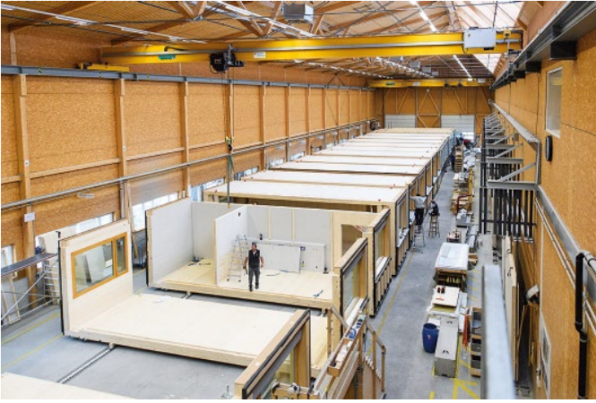
Bild 2. Die einzelnen Holzmodule werden – wetterunabhängig und systematisch – bereits im Werk nach definierten Ausbaustandards vorgefertigt
